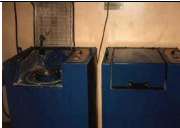
Slika 1. Visokoenergetski vibro mlin MH954/3 (KHD Humboldt Wedag A.G., Nemačka)
