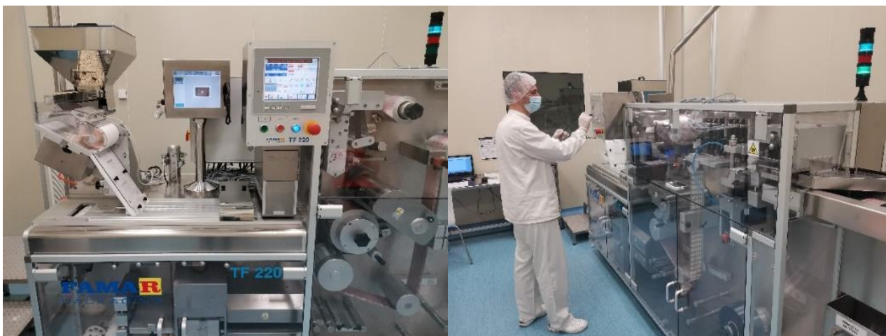
Mašina za blistiranje kapsula (Famar, Italija) Capsule blister packing machine (Famar, Italy)
